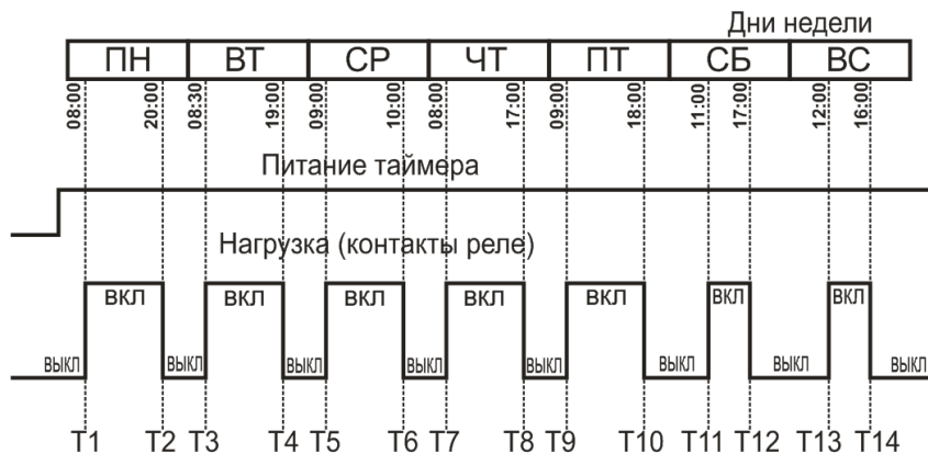
Рисунок 3.4 – Включение нагрузки на примере недельного режима работы
